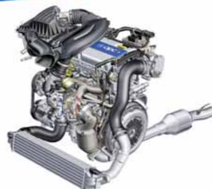
Eines der typischen Merkmale von OPC-Motoren ist die Turboaufladung. Der Vorteil sind hohe Literleistungen (siehe Technische Daten Seite 67) bei vergleichsweise kleinen Hubräumen. So besitzt der 240 PS starke 2,0-Liter-Turbomotor des Astra und Zafira OPC eine höhere Literleistung als ein Ferrari F430
